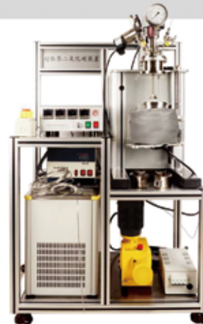
超临界CO 2 发泡装置 带有CO 2 进料单元和快速泄放单元，可自动控制CO 2 进料、泄放
