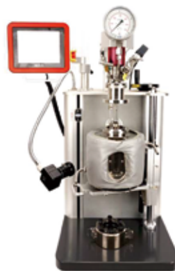
高压可视CO 2 发泡反应釜 适用于CO 2 发泡实验，带有对开蓝宝石视窗，可在高压下观察发泡状态
